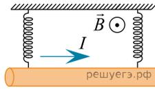
Если при отсутствии тока в проводнике длина каждой пружины была  $x_1 = 15$  см, то после того, как по проводнику пошёл ток  $I = 30$  А, длина каждой пружины  $x_2$  в равновесном положении стала равной ... см.
